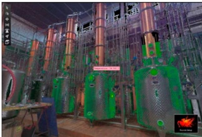
Ricostruzione interno di impianto industriale: sovrapposizione di immagini RGB, 3D e termiche
